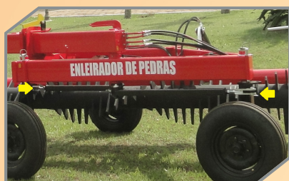
Barras traseiras para fácil alinhamento dos pneus.
