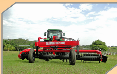
Rolo com tratamento de solda dura promovendo diminuição de desgaste.
