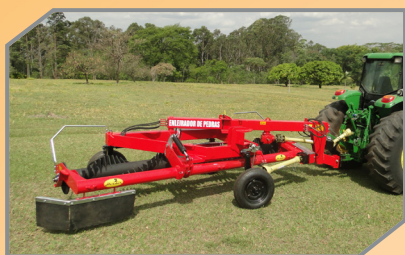
Sistema de transporte com largura de 2,3 metros.
