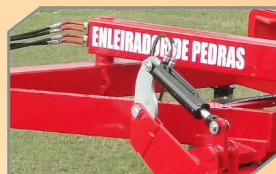
Sistema hidráulico para regulagem de altura e mudança de operação / transporte.
