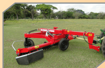
Sistema de posição de trabalho com angulação do rolo em 18° graus.
